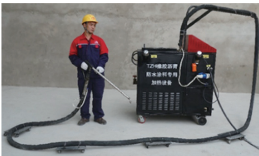
图3 加热(喷涂)一体设备
